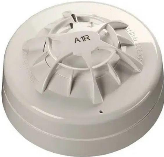
El detector de calor Orbis monitorea la temperatura mediante el uso de un solo termistor que proporciona una salida de voltaje proporcional a la temperatura del aire externo.
